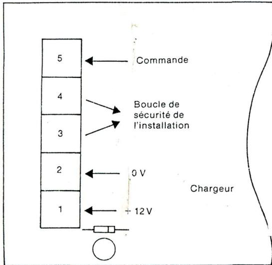
Une résistance de 820  $\Omega$  doit être insérée (en série avec la commande) pour l'état de veille de la VOL-K 115.
