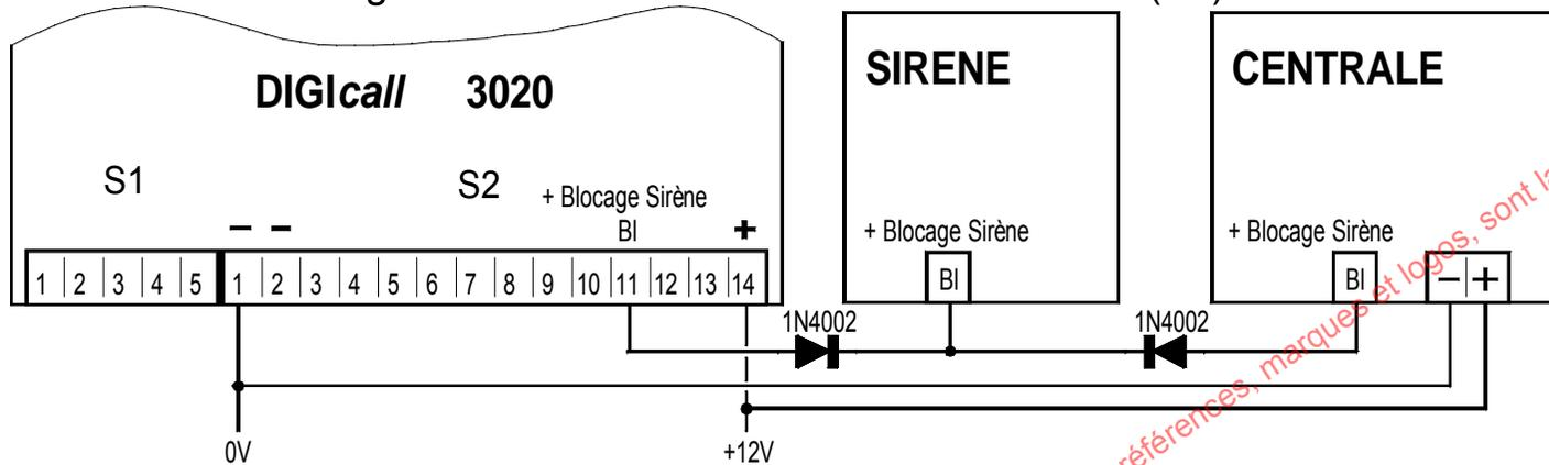
La sortie +12V de blocage sirènes ( borne 11 ) est active à +12V ( collecteur ouvert ) , seulement pendant l'écoute . Cela permet de bloquer le fonctionnement des sirènes pour effectuer de l'écoute .
