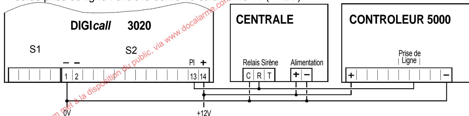
La sortie prise de ligne ( borne 13 ) est à 0V hors prise de ligne et en collecteur ouvert en prise de ligne.
