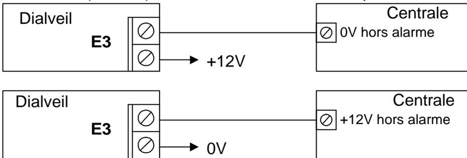
On doit trouver 12V hors alarme entre les deux bornes E3
