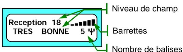
L'affichage de ces informations est présent 30 minutes, sans action sur  $\otimes$ . (sortie de paramétrage et mise sous tension)
