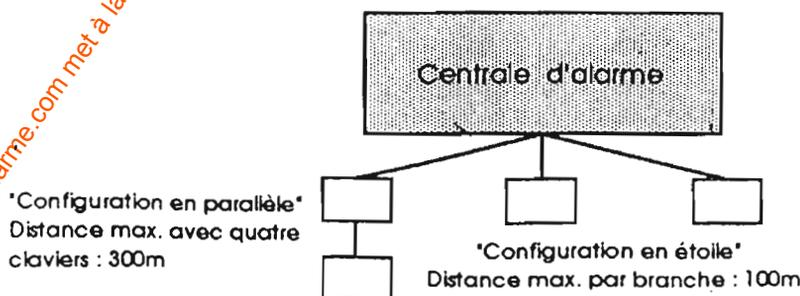
Fig. 7 Types de raccordement du clavier
