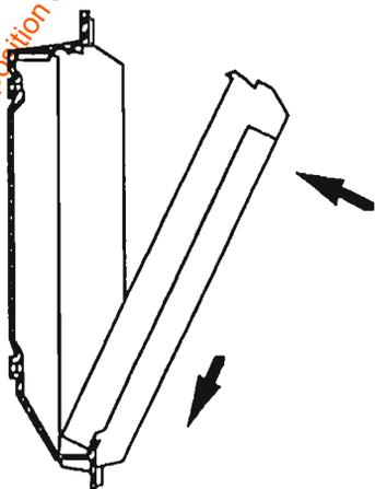
Fig.4 Mise en place du clavier
