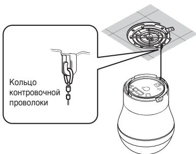
**Примечание:** Проволока безопасности разработана для того, чтобы позволить камере висеть на ней. Не прилагайте усилие большее, чем вес камеры на проволоку.
