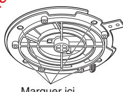
4. Posez la base de fixation de la caméra au plafond. Utilisez les vis (M4) aux emplacements que vous avez repérés ci-dessus pour fixer solidement la base de fixation de la caméra au plafond.
