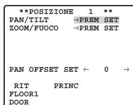
3. Utilizzare il joystick per posizionare la telecamera, e premere il tasto CAM (SET).
