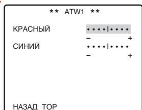
**Примечание:** Баланс белого регулируется в соответствии с телевизионной цветовой температурой, которую камера обнаруживает автоматически. Корректировка регулировки не может быть возможна если сильный источник света сверкает на экране.
