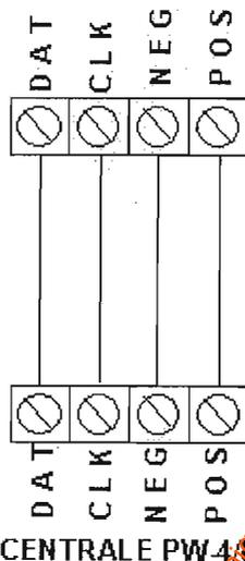
Le boîtier de contrôle se connecte sur le bus (bornes Pos, Neg, Clock et Data) de la centrale, comme un clavier. Le BC prend l'adresse du clavier N°4. Cela signifie que les options programmées pour le clavier 4, sont aussi affectées au boîtier de contrôle.
