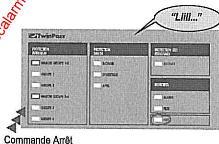
Pour vous permettre l'arrêt de votre système d'alarme depuis l'intérieur de votre habitation (cas où le clavier ou la télécommande sont placés à l'intérieur des zones protégées), certains détecteurs peuvent être configurés en déclenchement retardé de 20 s.
