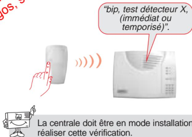
La centrale doit être en mode installation pour réaliser cette vérification.
