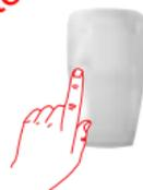
Si le voyant test ne s'éclaire plus, le bloc lithium est à remplacer.
