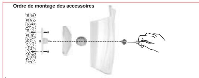
Pour des raisons de sécurité et de durée de vie de la pile du détecteur, le montage du pion d'autoprotection est obligatoire. En cas d'oubli ou de montage incorrect du pion d'autoprotection, le voyant rouge clignote en permanence quand le détecteur est clipsé sur son socle.
