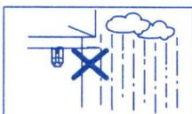
Le SensCAM est prévu pour une utilisation en intérieur, ne pas l'installer dehors.
