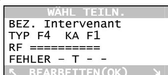
Die Buchstaben B, T, S und O stehen jeweils für Battery (Batterie), Tamper (Sabotage), Supervision (Überwachung) und Others (andere Störungen). Besteht keine Störung, erscheint ein Strich auf der Anzeige.
