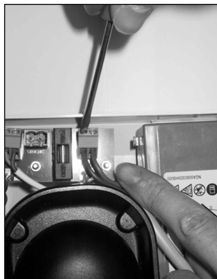
Figure 9a : Branchement du bus de la centrale Figure 9b : Branchement de l'alimentation
