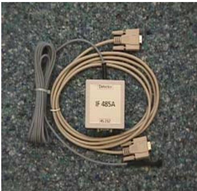
Le module interface PIR-IF485A est disponible en tant qu'accessoire. Il est préconfiguré et équipé de tous les connecteurs nécessaires à tout détecteur de la série IR 450. Aucune alimentation externe, ni aucune autre connexion n'est requise.
