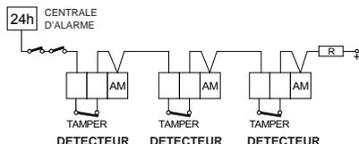
R = résistance d'équilibrage: 1,5K -2,2K -4,7K. Si la connection est effectuée avec des centrales à entrées équilibrées, il faut utiliser les résistances livrées avec la centrale.
