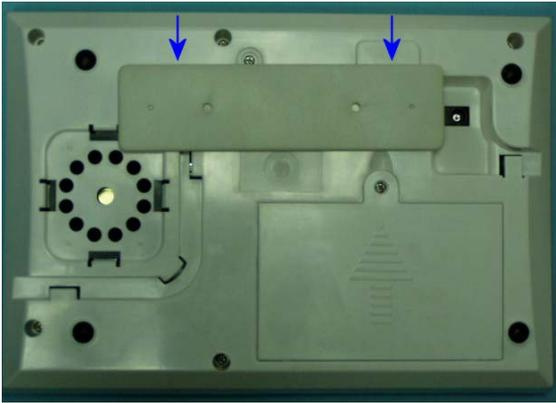
Retirez le support de montage au mur en le déclipant vers le bas.
