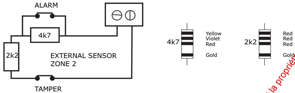
Figure B.3 Connexion d'un contact externe
