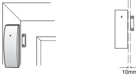
Schéma B.2 Contact d'ouverture
