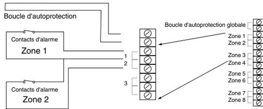
Figure 11. Connexions de zones NF à 4 conducteurs
