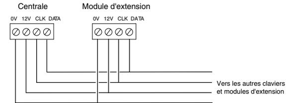
Figure 13. Raccordement de modules d'extension 9954 et 9955
