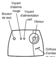
Le voyant d'alimentation vert clignote environ une fois par minute pour indiquer que le détecteur fonctionne correctement. Si l'on relève la présence de monoxyde de carbone, le voyant rouge s'allume en continu et le vibreur retentit.
