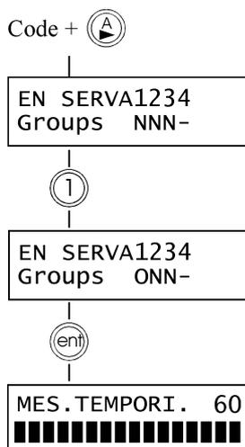
Sélectionner le ou les groupes à mettre en service en appuyant sur la touche correspondante au N° du groupe requis. Par exemple, pour mettre en service les groupes 1 et 2 appuyer sur les touches 1 et 2. L'afficheur change alors l'état du groupe et indique sa sélection pour la mise en service par l'affichage de la lettre O. Taper sur la touche **Ent** pour lancer la procédure de mise en service pour les groupes sélectionnés.
