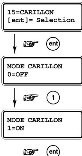
L'option **15=CARILLON** permet l'activation (**1=ON**) ou la désactivation (**0=OFF**) du mode Carillon.
