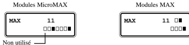
Pour les modules MicroMAX, le graphique affiché sur le clavier représente les sept leds du module. De la même façon, pour les modules MAX, le graphique affiché sur le clavier représente les deux leds du haut et les quatre leds du bas. Les différentes combinaisons sont :
