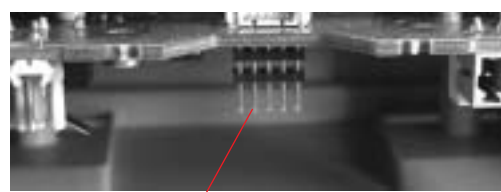
Connecteur pour recevoir la carte d'extension
