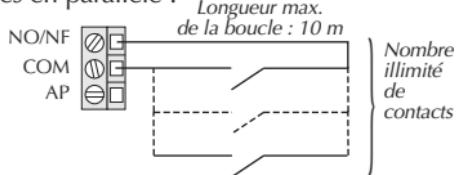
Le raccordement d'une boucle autoprotégée doit être effectué avant le branchement de la pile. La reconnaissance de cette dernière se fait alors automatiquement lors du branchement de la pile.
