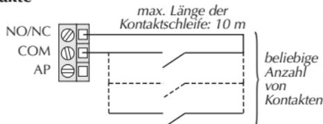
**Das Erkennen einer Kontaktenschleife mit Sabotageschutz erfolgt automatisch, wenn der Anschluss im stromlosen Zustand ausgeführt wird.**
